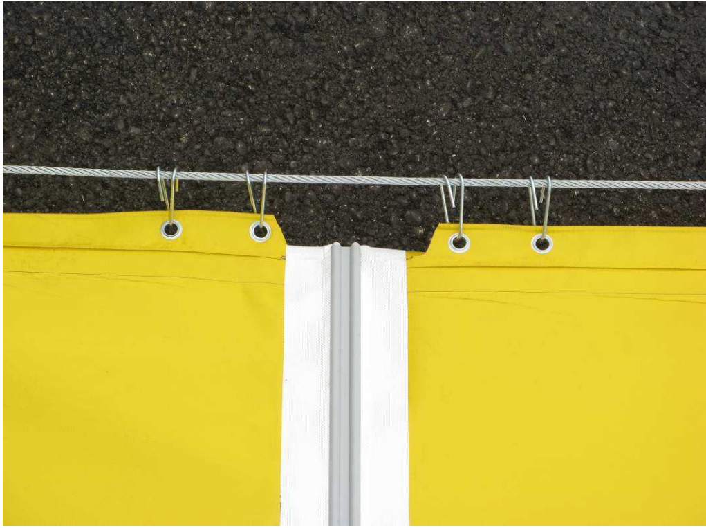
Fertig montierte Ventilationslutte mit dem EASY JOINT System
